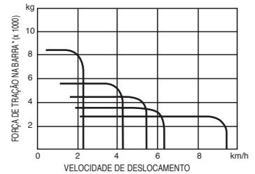
\* A tração depende das condições do terreno e do peso do equipamento
